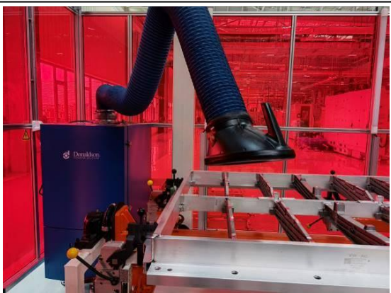
手工焊接吸气臂及移动式焊接烟尘净化器
