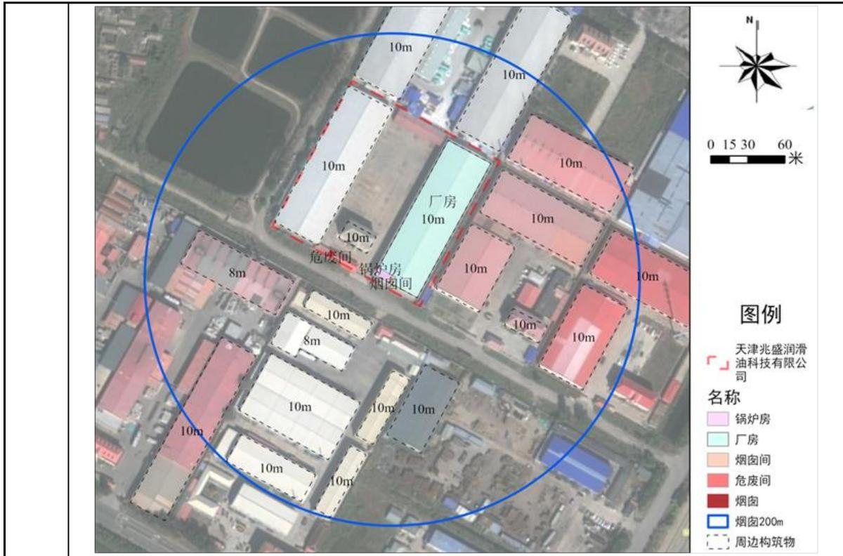
图 4-1 锅炉房烟囱周围 200m 范围内建筑物高度示意图
