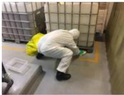
使用吸收棉将洒漏的化学品清理干净 3 清理中
