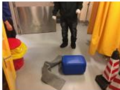
运输化学品过程中容器被撞倒，容器破裂导致化学品泄漏
