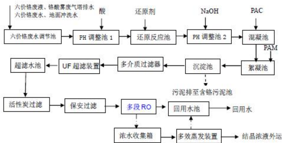
图 3.2-9 六价铬废水循环工艺流程图
