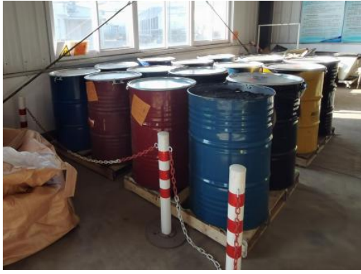
危废暂存间含铁粉切削污泥
