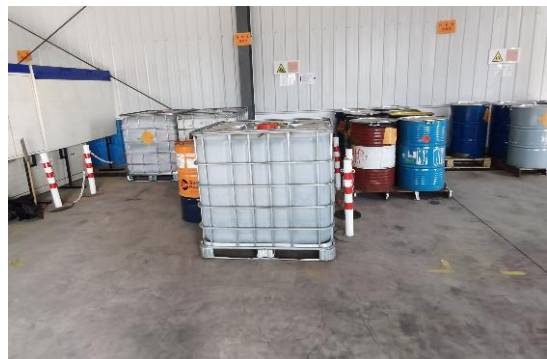
危废暂存间 含油废水（塑料桶）、含油污泥（铁桶）
