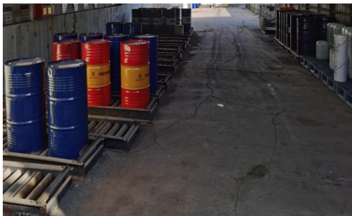
原料库防渗漏托盘
