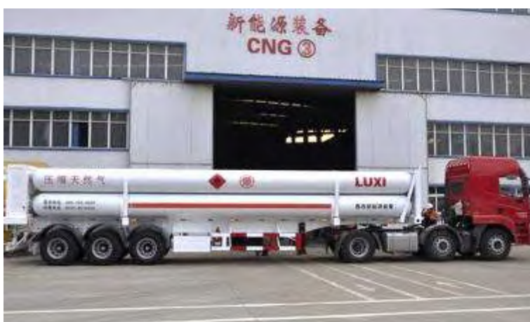
图 3.2-1 压缩天然气长管拖车
