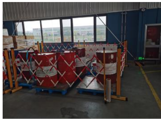
原料存放间包装桶底部防渗漏托盘
