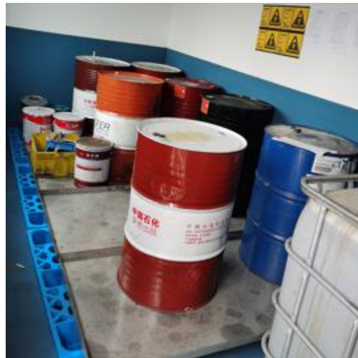
原料存放间容器底部防渗漏托盘
