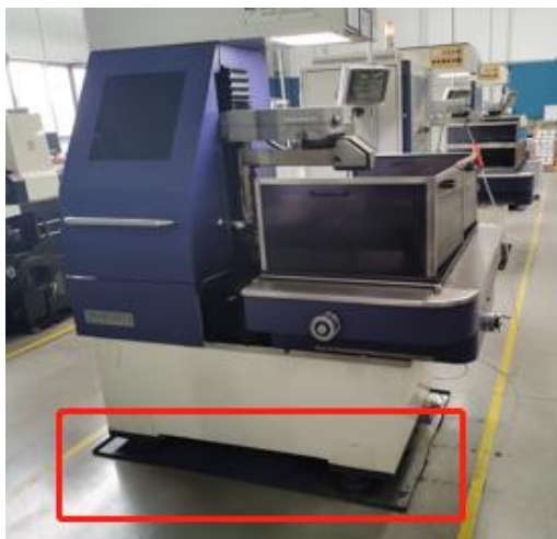
切削设备底部防渗漏托盘
