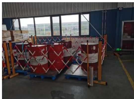
原料存放间包装桶底部防渗漏托盘
