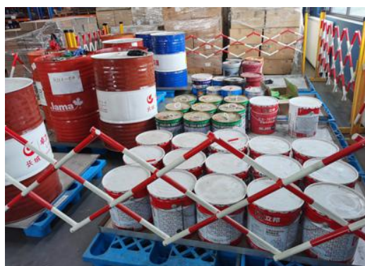
原料存放间包装桶底部防渗漏托盘
