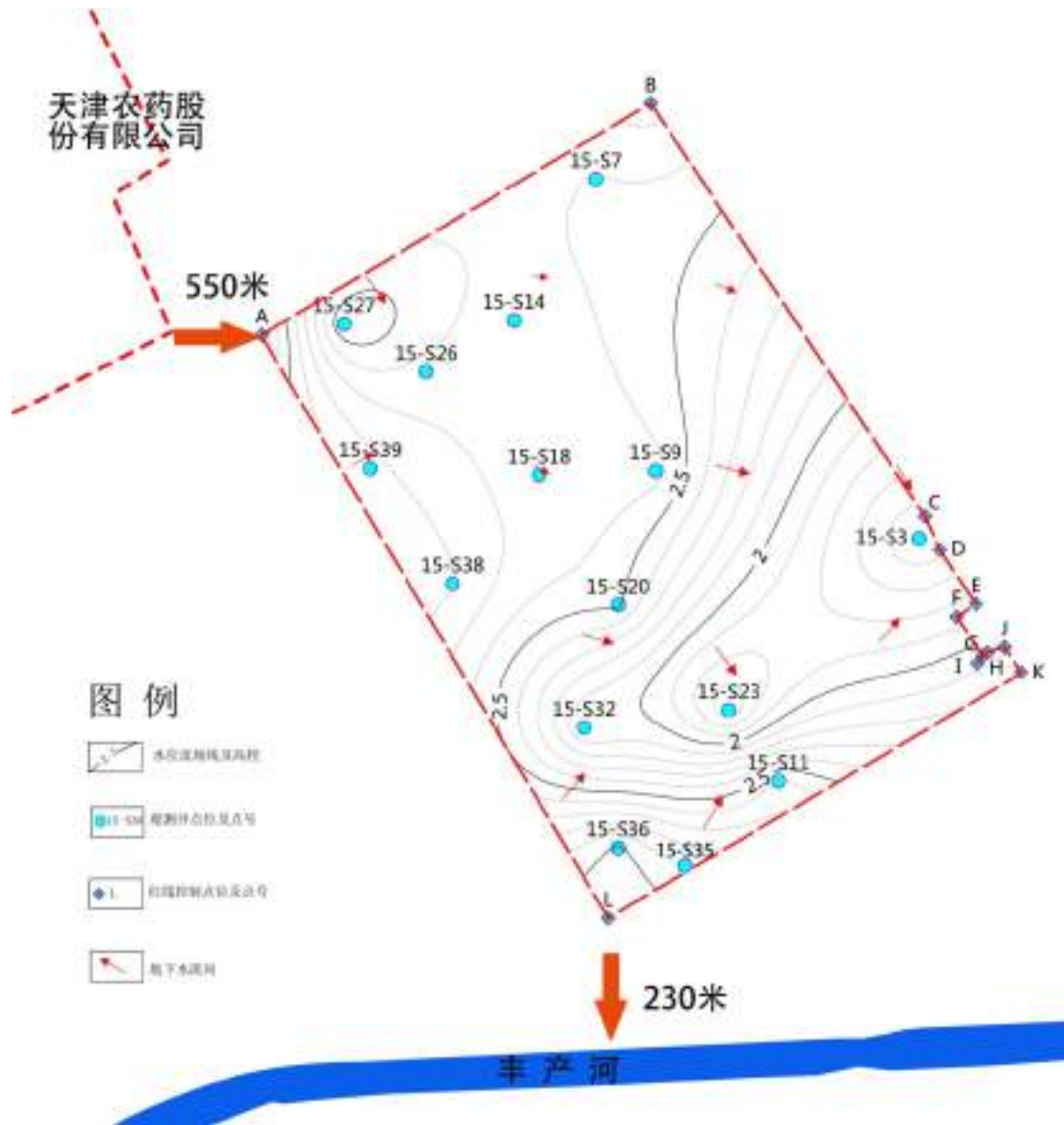
图 4.3-1 场地第 2 层地下水流场图及周边情况示意图
