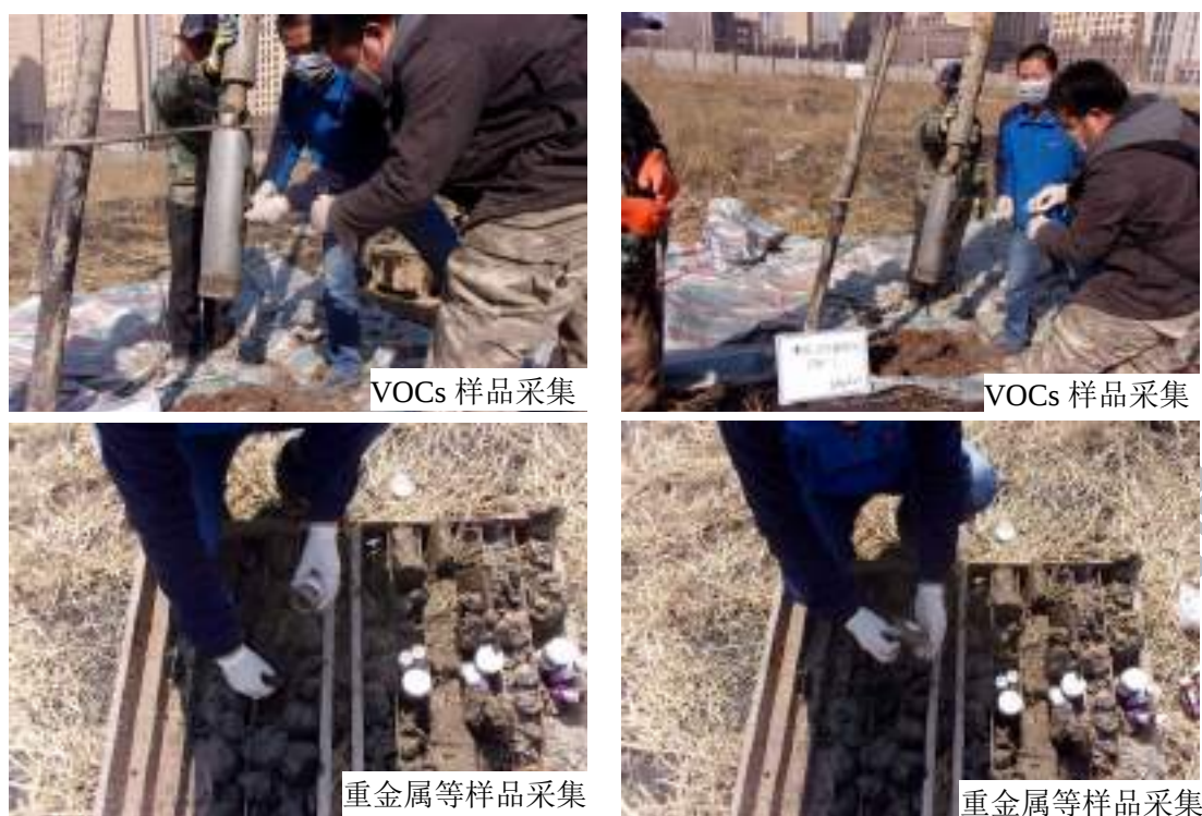
图 4.3-1 现场土壤样品采集
