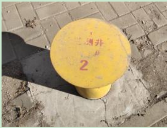
图 1 地下水监测点 S2 井
