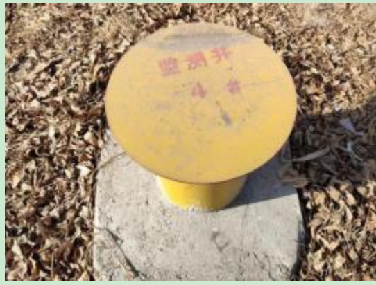
图 3 地下水监测点 S4 井
