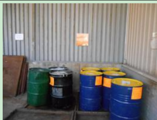
图 2 危废间内部分类存放及防渗漏托盘
