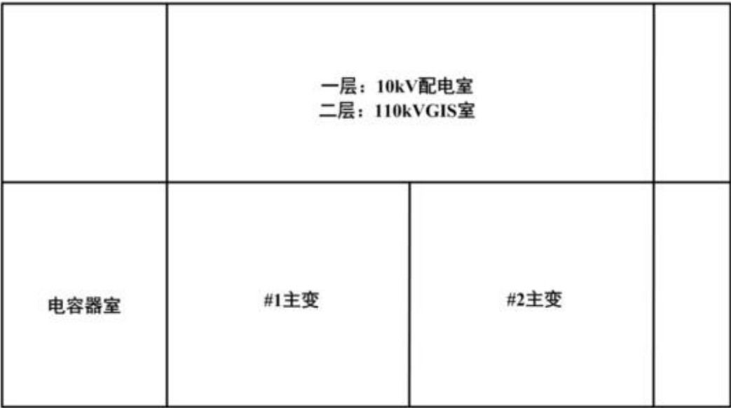
图 3.1 本项目 110kV 变电站平面布置简图
