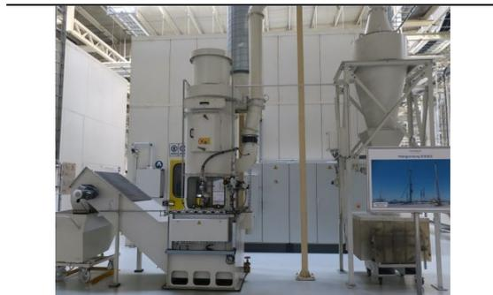
图 3 旋风+湿式除尘照片
