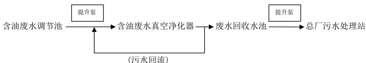
图 4.1 含油废水处理工艺流程图
